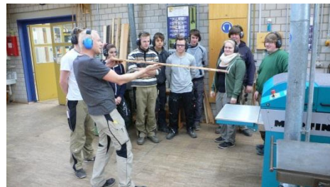
Thomas Wolf bespricht mit den Schülerinnen und Schülern der Berufsfachschule Holz das Hobelergebnis nach der Bearbeitung eines Massivholzbrettes mit der neuen Dickenhobelmaschine.
