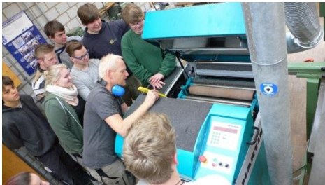
Thomas Wolf, technischer Lehrer der Gewerblichen Schulen Donaueschingen, erklärt Schülerinnen und Schülern der Berufsfachschule Holz an der neuen Dickenhobelmaschine das Prinzip der „ziehenden Schnitts“ anhand der mit bombierten Messern ausgestatteten Welle.
